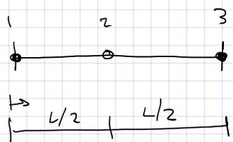
$$\begin{bmatrix} u_1 \\ u_2 \\ u_3 \end{bmatrix} = \begin{bmatrix} 1 & 0 & 0 \\ 1 & L/2 & (L/2)^2 \\ 1 & L & L^2 \end{bmatrix} \begin{Bmatrix} c_1 \\ c_2 \\ c_3 \end{Bmatrix}$$
